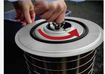
Die Ringmutter lösen und den Deckel der INNOLET®-Filterpatrone abnehmen.
