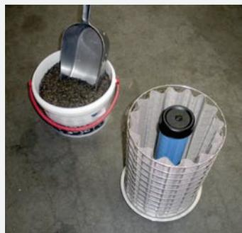
Das Substrat in den Ringraum einfüllen.
