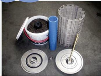
Das alte Substrat aus der Filterpatrone entfernen, z. B. in einen Behälter füllen.
