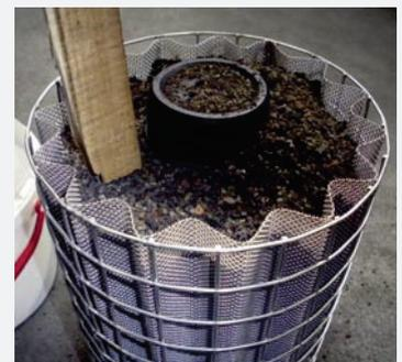
Das Substrat leicht verdichten. Die Filterpatrone muss bis zur Oberkante gefüllt sein.
