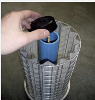
Die Schutzkappe aus dem Substrateimer aufsetzen.
